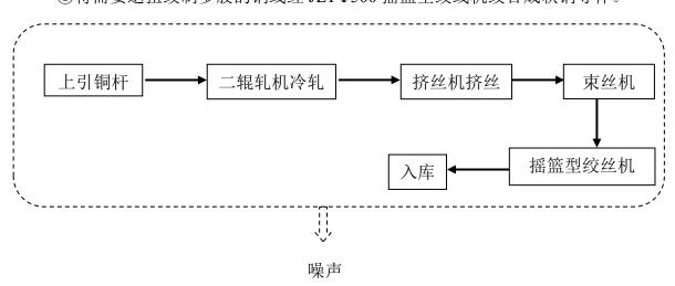
图 3.7-5 铜绞软线生产工艺流程图
