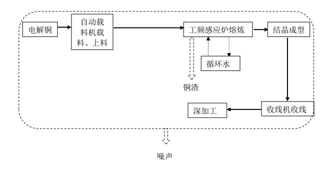
图 3.7-1 上引铜杆生产工艺及污染流程流程图
