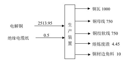
图 3.6-1 物料平衡图 单位 t/a
