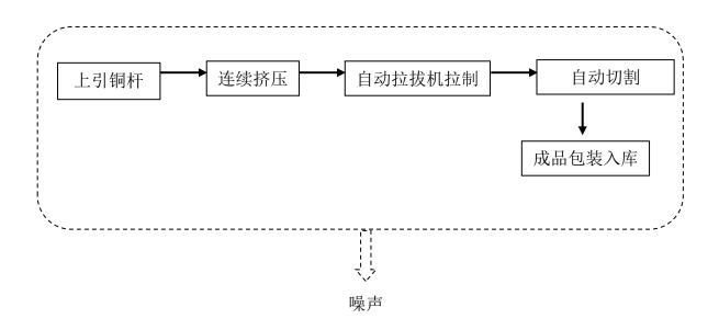
图 3.7-3 铜母线生产工艺及污染流程图
