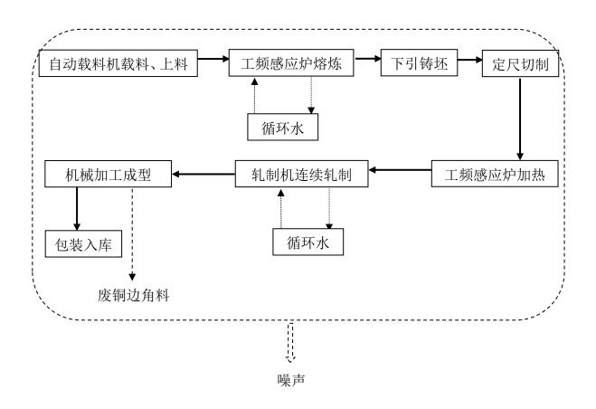
图 3.7-2 铜瓦生产工艺及污染流程流程图
