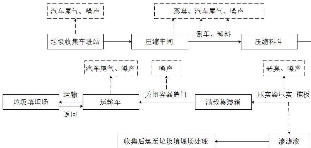
图 1 垃圾转运站运营期工艺流程及产污节点图
